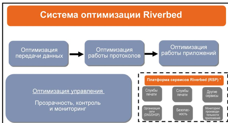
**Рисунок 18.** RSP работает в защищенном разделе RiOS и обеспечивает развертывание дополнительных сервисов
