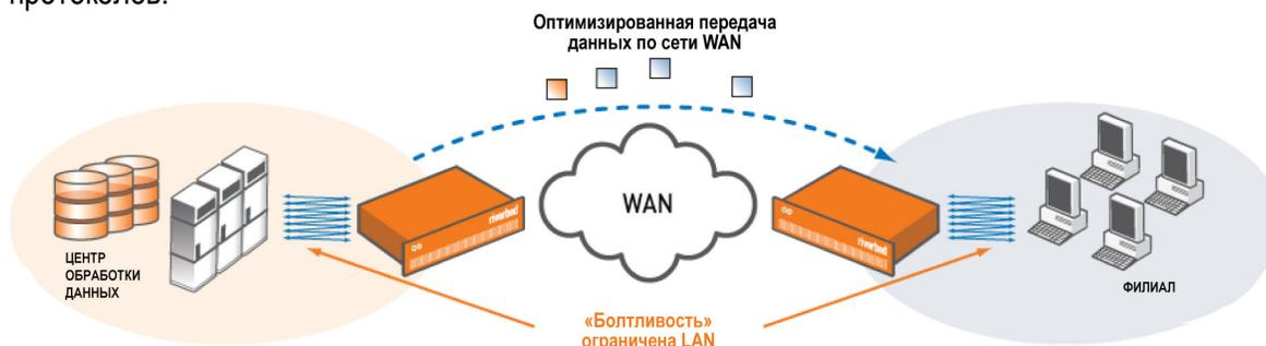
**Рисунок 11.** Оптимизация работы приложений может исключить до 98 % операций передачи данных, которые создаются протоколами прикладного уровня
