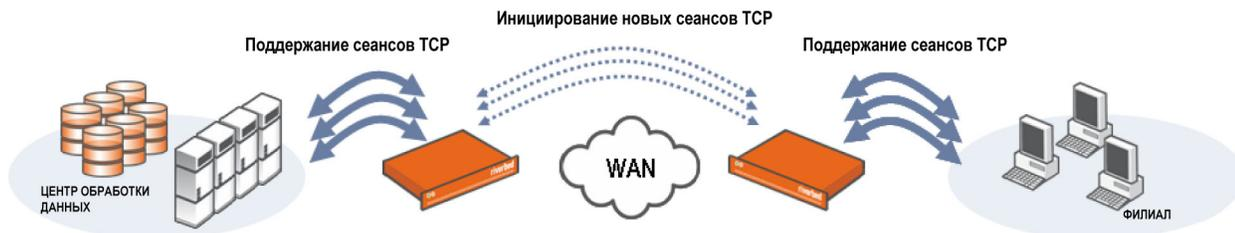
**Рисунок 2.** RiOS устанавливает новые сеансы TCP в сети WAN, что позволяет оптимизировать передачу данных без изменений в существующей инфраструктуре WAN
