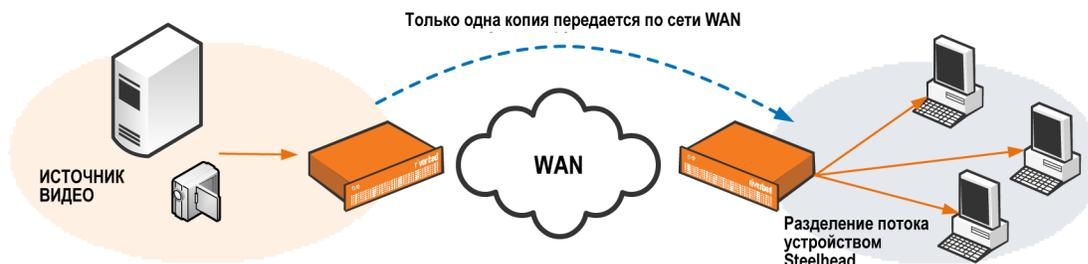
Рисунок 14. По сети WAN передается только одна копия потока реального времени; затем устройство Steelhead разделяет этот поток и доставляет его пользователям, передавшим запросы
