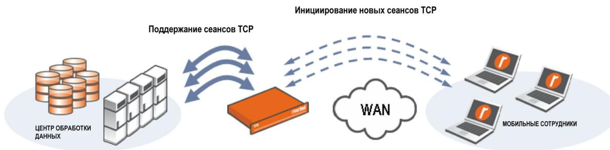
**Рисунок 3.** RiOS оптимизирует TCP-подключения в сети WAN непосредственно с компьютера удаленного пользователя
