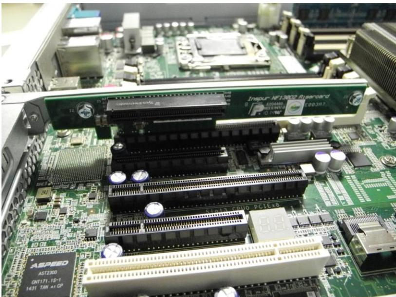
Приятной неожиданностью для бюджетного решения стал диагностический 2-значный дисплей на материнской плате. А над дисковой корзиной 2 места для установки NHS дисков размера 2». То есть в данный одноюнитовый сервер можно установить 4 диска размера 3.5» с горячей заменой и 2 диска 2.5» без горячей замены. Очень неплохой результат.
