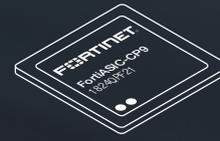
Контент-процессоры – это вспомогательные процессоры ЦП. Они берут на себя ресурсоемкую обработку и проверяют содержимое, ускоряя таким образом функции безопасности.
