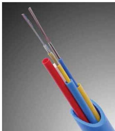
При использовании подобных систем в высотных зданиях в стояке прокладывается гибкая трубка с предварительно установленными микротрубками. На каждом этаже нужно число микротрубок отводится с помощью специальных Y-образных коннекторов. При появлении нового абонента волокно вдувается до его квартиры или офиса из центральной точки. Систему, предлагаемую компанией R&M, можно использовать в 20-этажном здании высотой до 75 м.
