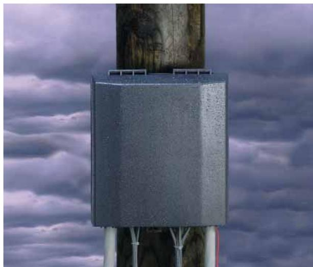
робки является изделие Venus FLA (Fiber LArge), входящее в семейство распределительных коробок Venus компании R&M. Коробка Venus FLA выполнена в крепкой герметичной конструкции и может эксплуатироваться в широком температурном диапазоне. Она позволяет устанавливать до 6 сплайс-кассет и до 12 разъемов (E-2000, SC, ST, FC). Степень защиты изделия – до уровня IP54. Специальный вариант коробки Venus FLA может вмещать сплиттер 1:16 и 24 адаптера для подключения разъемов.
