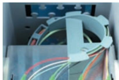
Концепция защиты кабеля и волокна: Минимальный радиус изгиба пigtails (40 мм) гарантирует оптимальную передачу. Защита буферных трубок в узлах ввода и вывода из монтажных каналов. Механическая защита при помощи ламелей.
