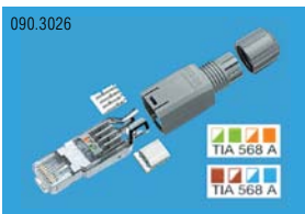
FM45 коннектор IP20, 4P, TIA 568A (AWG26-23) Артикул - R312231
