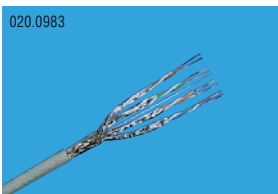
Промышленный кабель Cat.7, S/FTP, 4P, 900 MHz, FL.RET, 100 m Артикул - R313685
